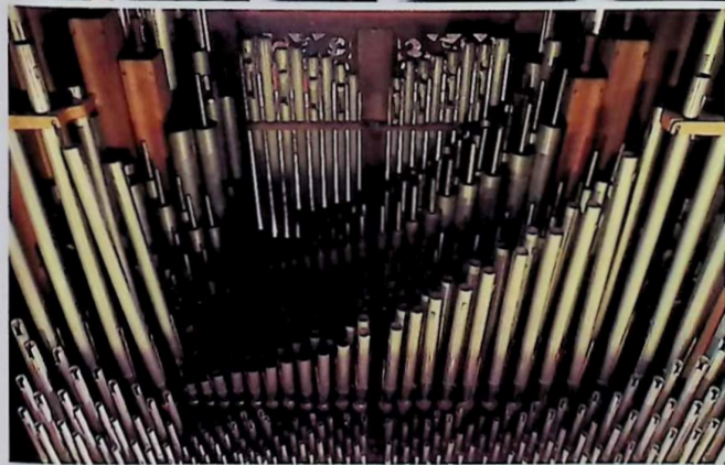
Vues intérieures. En haut, tuyaux de bois et de trompette. En bas, disposition des différents tuyaux : mixtures, cornets...
